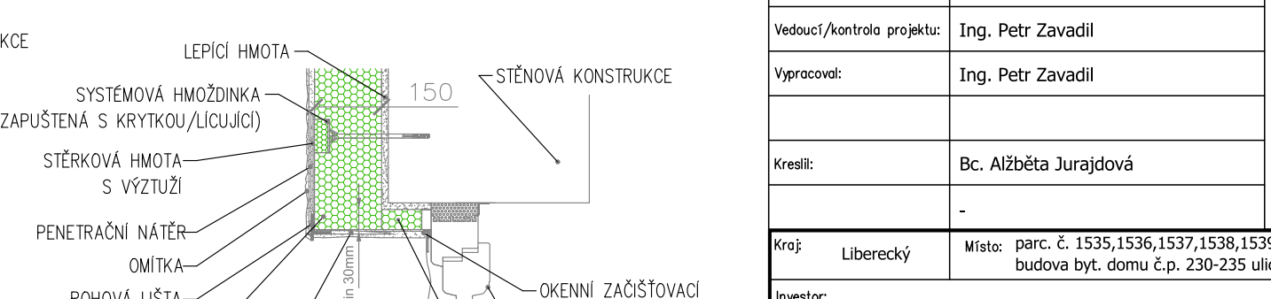
DETAIL B - OSAZENÍ OKEN V MÍSTECH ZATEPLENÍ FASÁDY KZS (ETICS), M 1:10
